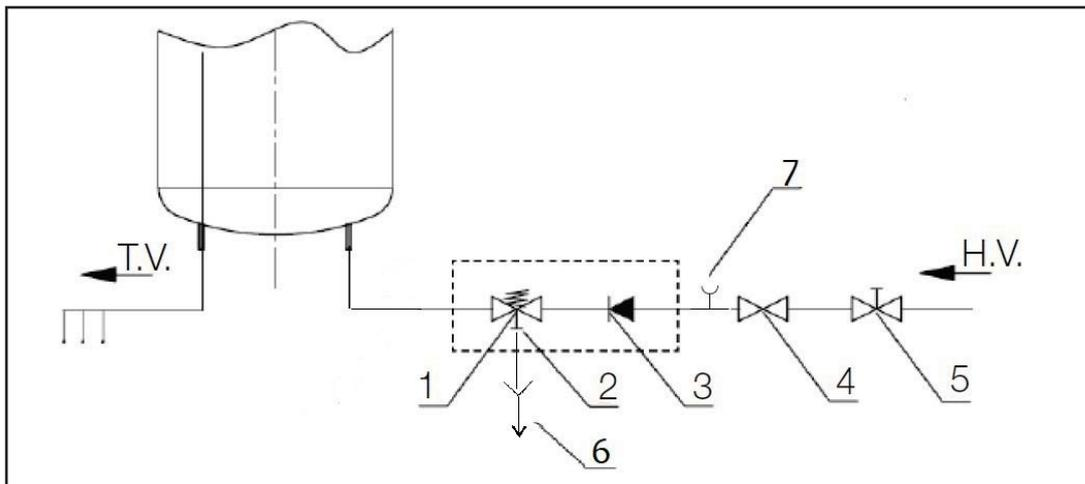
**SRB/BIH/MNE** 1. Sigurnosni ventil 2. Ventil za testiranje 3. Nepovratni ventil 4. Redukcioni ventil 5. Zaporni ventil 6. Ekspanziona posuda 7. Ispitni nastavak H.V. Hladna voda T.V. Topla voda
