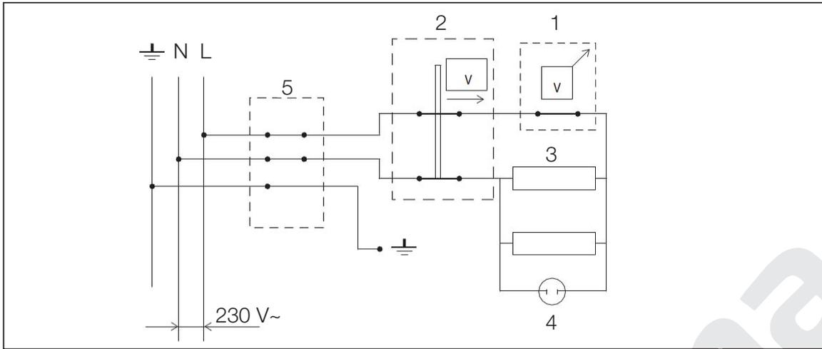
**SRB/BIH/MNE** 1. Termostat 2. Sigurnosni termostat 3. Grejač 4. Signalna sijalica 5. Klema L- Faza N - Nula  $\perp$  - Uzemljenje
