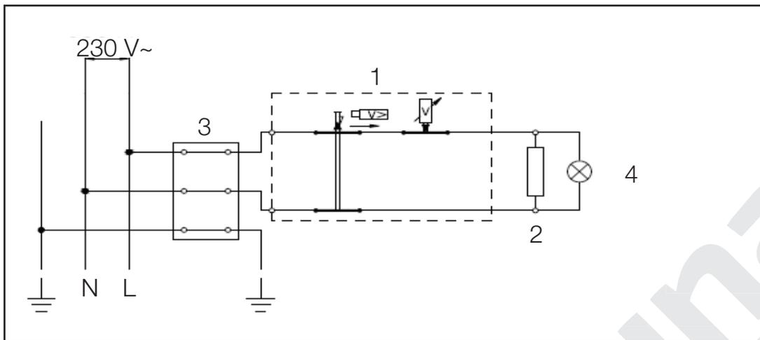
**SRB/BIH/MNE** 1. Termostat 2. Grejač 3. Priključna klema 4. Signalna sijalica L - Faza N - Nula  $\perp$  - Uzemljenje
