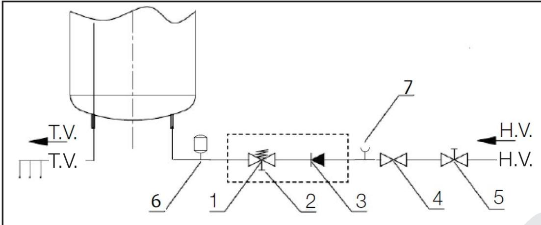
**SRB/BIH/MNE** 1. Sigurnosni ventil 2. Ventil za testiranje 3. Nepovratni ventil 4. Redukcioni ventil 5. Zaporni ventil 6. Ekspanziona posuda 7. Ispitni nastavak H.V. Hladna voda T.V. Topla voda
